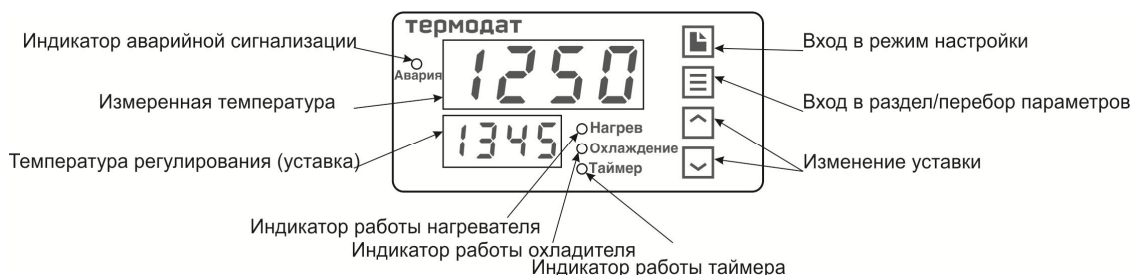
Рисунок 6 – Описание индикаторов и кнопок управления прибора 12К6-D8-Н/...
