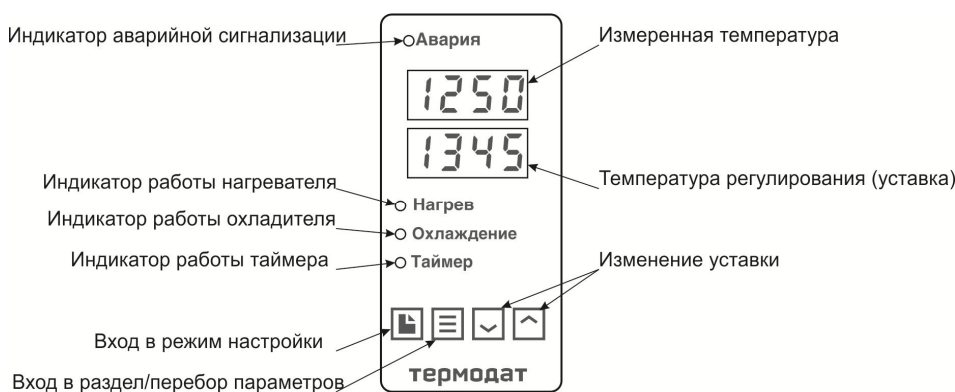
Рисунок 5 – Описание индикаторов и кнопок управления прибора 12К6-D8/...
