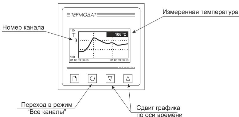
В режиме **«все каналы»** на экране отображаются текущие значения параметров на всех каналах одновременно.
