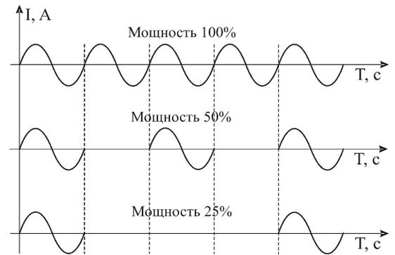
3) В методе широтно-импульсной модуляции (**ШИМ**) нагрузка включается на долю периода ШИМ, который задается пользователем. Среднее значение выводимой мощности, в процентах от полной мощности нагревателя, определяется отношением времени включения к периоду ШИМ.
